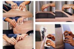
图4-18 油泥模型制作
